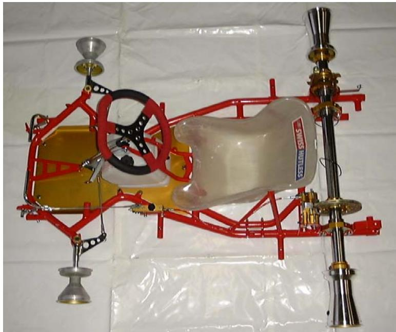
PHOTO VUE DE DESSUS DU CHÂSSIS COMPLET IDENTIQUE À L'UN DES MODÈLES PRÉSENTÉS À L'HOMOLOGATION SANS PARE-CHOCS, CARROSSERIE NI PNEUMATIQUES
